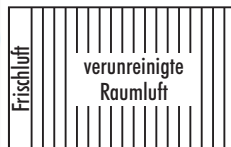
Selbstlüftung: Bei geschlossenen Fenstern und Türen durch Undichtigkeiten
